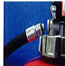
× 緊結ネジの破損 × ホースの脱落
