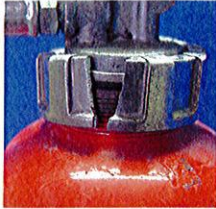
× キャップの破損
