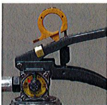
× 安全栓の抜けかけ
