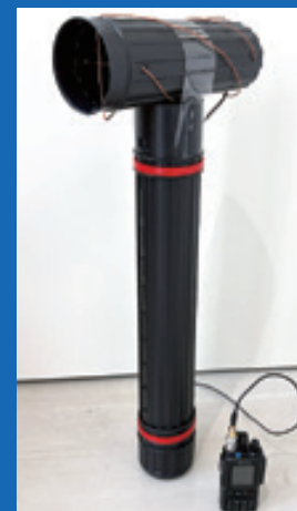
高知県南国市モデルQFHアンテナ
